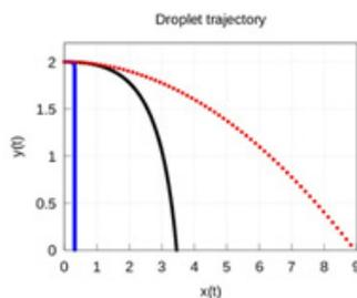
Trayectoria de una gotita de 160 micrómetros (azul) y de 1 milímetro (negra) usando la aproximación (8)-(9) comparada con la de un proyectil que cae sin rozamiento (en rojo).
